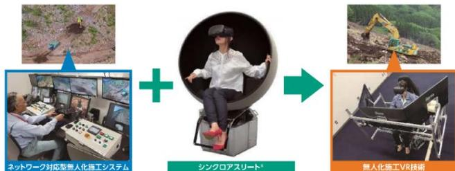
360度視界(映像) + 音 + 傾き + 振動 = 搭乗操作に近い感覚で遠隔操作
