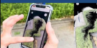
絶対座標付きの点群を作成します。点の1つ1つに平面直角座標系の絶対座標が入ります。絶対座標の誤差は±10cm程度です。複数回にわけて取得した点群は絶対座標で自動的につながるので、広い空間でも点群を取得できます。
