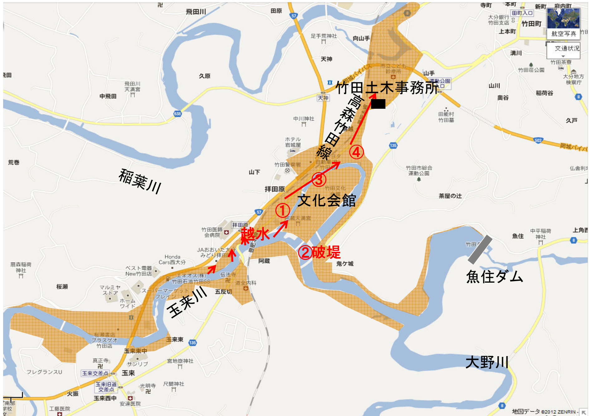
竹田市における浸水図と魚住ダム
