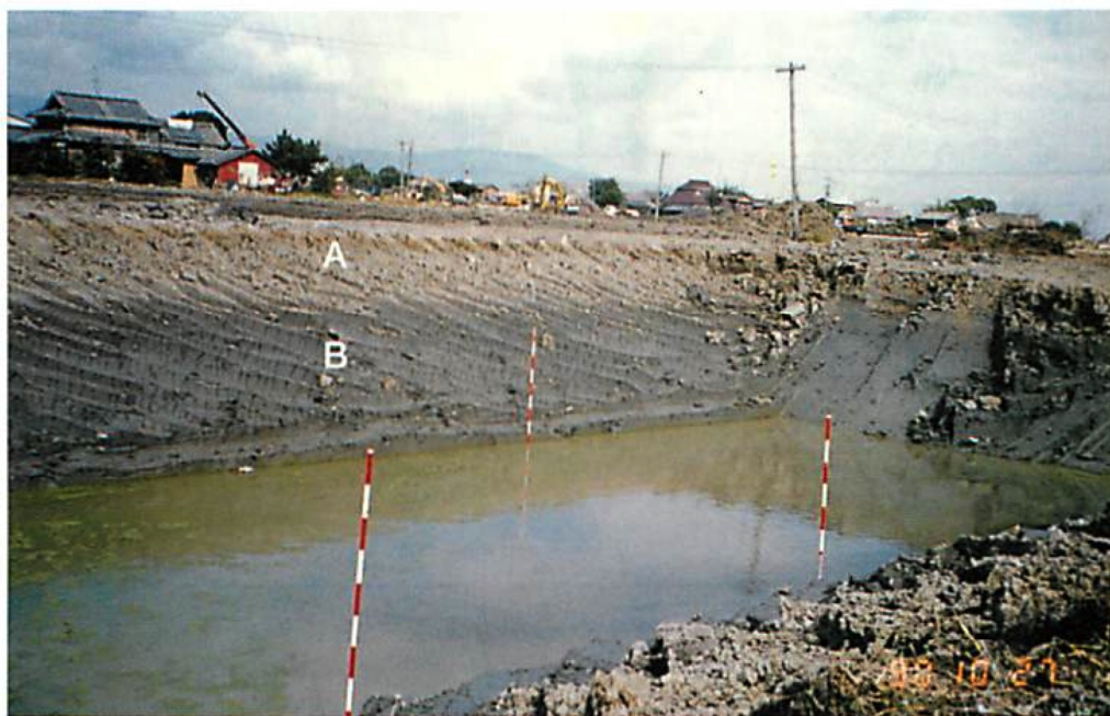
図2-7 有明海北岸低地の表層を占める非海成粘土層(佐賀市瓦町)。A, Bは非海成粘土層の敷揚部分と非敷揚部分の違い。海成粘土層はこれらの直下には存在する。
