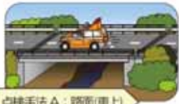
点検手法A: 路面(車上)
