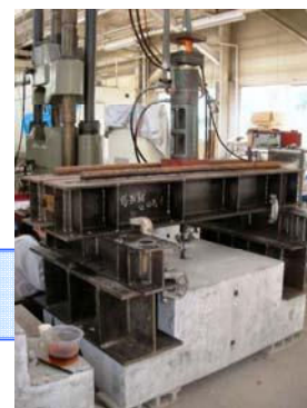
あと施工アンカーの引抜き試験
