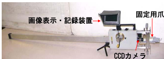
CCDカメラを用いた孔内自動検査装置の外観
