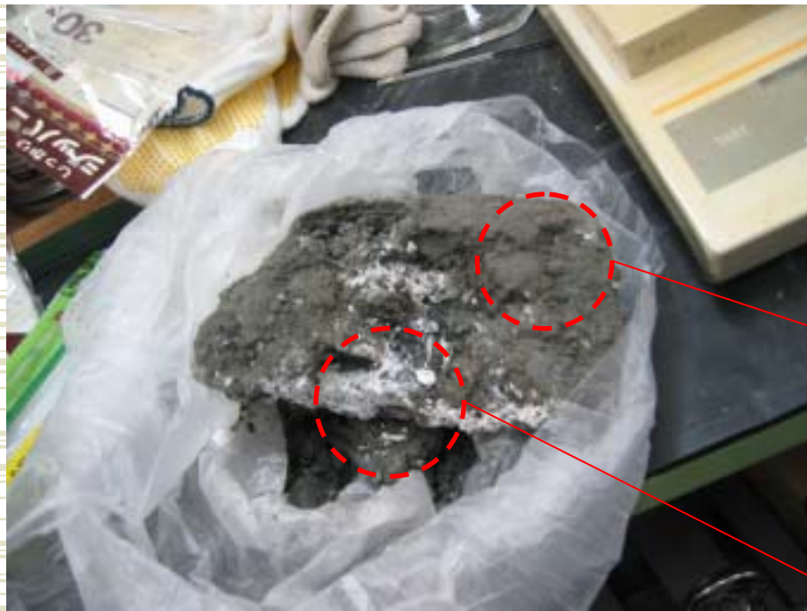
混合ムラのある改良体
