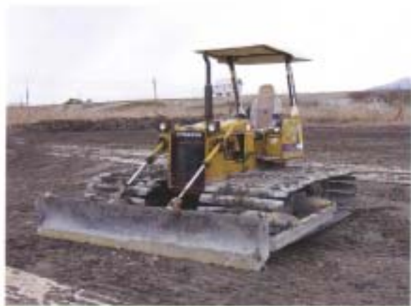
23. 敷均し機械 (超湿地ブルドーザ)
